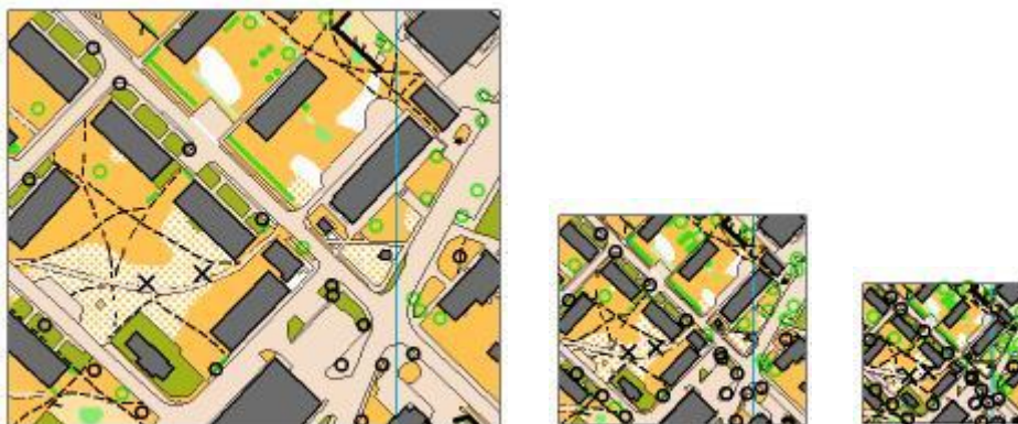
Rys. 1. Ten sam fragment mapy w skali 1:5000, 1:10 000 i 1:15 000. Łatwo zauważyć, że na mniejszej skali nie możemy pomieścić wielu szczegółów – mapa staje się nieczytelna.
